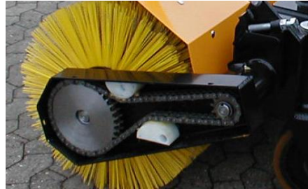
Automatisk stramning af kæden
