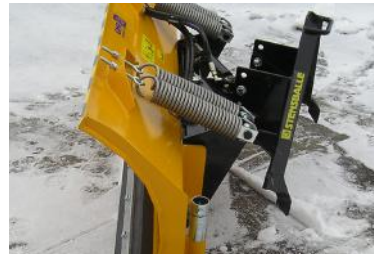
Fjäderutlösning säkrar vid påkörning
