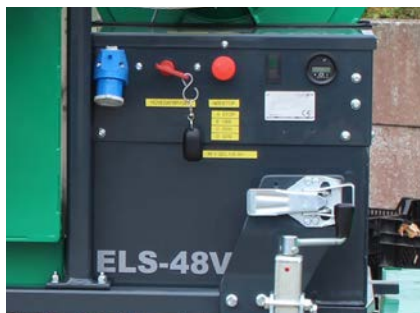
Översiktlig och lättåtkomlig kontrollpanel med bl a 220-voltsanslutning för laddning
