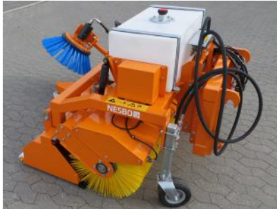
Vatten anläggning - 100 lit.
